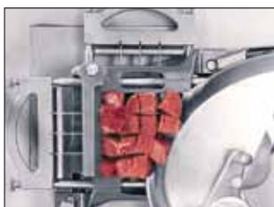
Mit Hilfe verschiedener Gattersätze erzielt man unterschiedliche Würfel-Größen. Bis zu 4 mm kleine Würfel sind möglich.
