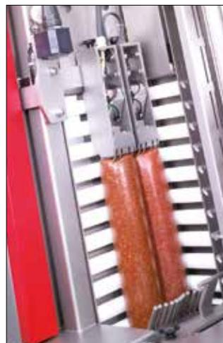
Die Einlegelänge des DIVIDER 660+ beträgt 850 mm (1000 mm optional). Bis zu vier Produkte können gleichzeitig aufgeschnitten werden.
