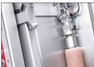
Der patentierte Vakuumbreifer (optional) hält weiche Produkte wie Brühwurst zuverlässig und sorgt damit für mehr Produktionssicherheit.
