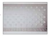
Noppenblech: Zwischen den Noppen entsteht ein Luftpolster, auf welchem das Produkt zum Messer geführt und die Produktreibung verringert wird.
