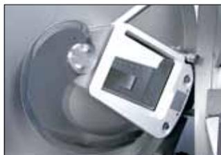
Ein Blick in den Messerkasten zeigt ein dünnes Messer für einen exakten Schnitt.
