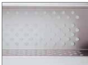
Noppenblech: Zwischen den Noppen entsteht ein Luftpolster, auf welchem das Produkt widerstandslos zum Messer geführt wird.
