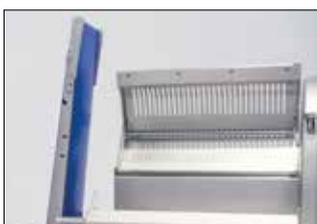
Wie zahlreiche Maschinen-Komponenten lässt sich auch das Austragband ohne Kraftaufwand in die optimale Reinigungsposition bringen. Eines von zahlreichen Beispielen für das ergonomische Design des PUMAs.
