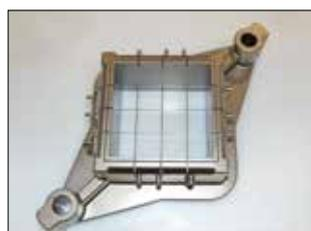
Zum Schneiden von Käsewürfeln wird ein spezielles Käsegatter eingesetzt.
