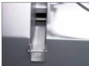
Reinigungs kanal für besseren Ablauf von Flüssigkeiten, z.B. Fleischsaft, Spülwasser.
