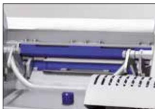
Mit dem Schließbügel wird der Trennschieber betätigt. Dieser fährt mit einer Kurvenbewegung. Nur dadurch wird die praktische Ein-Hand-Bedienung möglich und die Kammer bis zum Maximum gefüllt.
